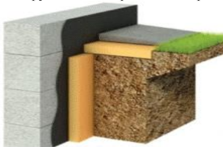
Рис. 3. Теплоизоляция и гидроизоляция фундамента
