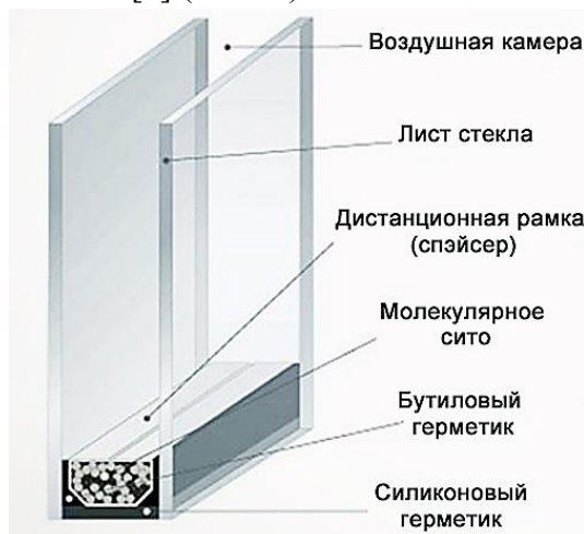
Рис. 2. Схема двухслойного светопрозрачного ограждения
