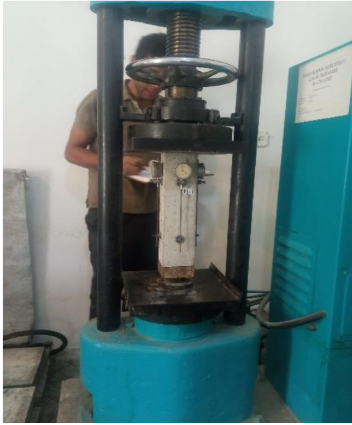
4-rasm. Yordamchi namunalar sinash (a) va buzilish ko'rinislari (b)
