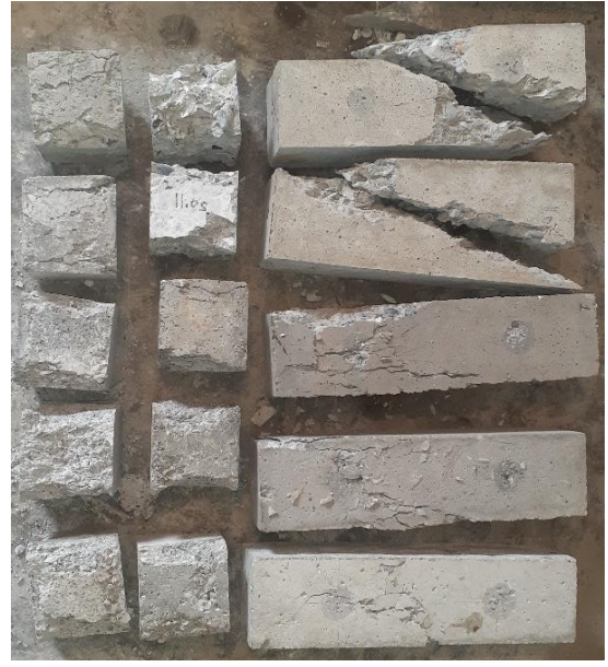
4-rasm. Yordamchi namunalar sinash (a) va buzilish ko'rinislari (b)
