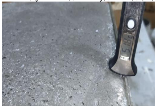
Расм. Газобетон қоришмаси ва намунанинг ғоваклик ўлчамини аниқлаш.
