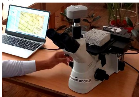
Расм. Газобетон қоришмаси ва намунанинг ғоваклик ўлчамини аниқлаш.
