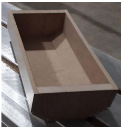
Rasm-2. Bordjur uchun qolip va plastik suv idish qopqoqlar
